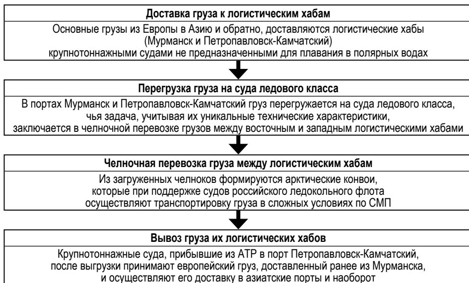
Рис. 1. Схема реализации концепции челночных перевозок по СМП Источник: составлено на основе [10].
